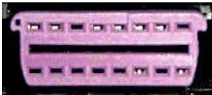
OBD-2-Stecker mit Belegung
