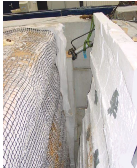
Bild 9. „Ausbauchungen“ in der EPS-Schicht nach Versuchsende
